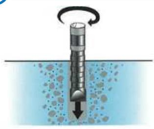
専用キャップをイーグルアンカーにセットし、ゆっくり廻しながら挿入してください。
